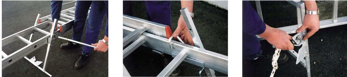
Dopo aver infilato la barra all'interno del piolo della scala, bloccare con i perni di sicurezza e le apposite coppiglie.
